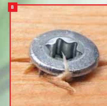
Afbeelding B: Een traditionele spaanplaatschroef: Splinters en splijten van het hout.
