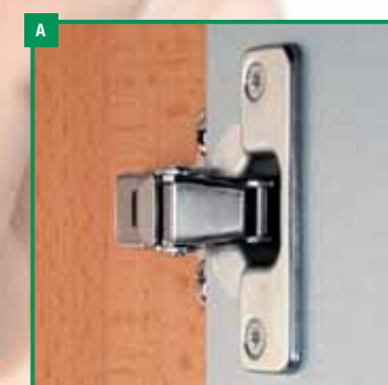
Afbeelding A: De SPAX® met MULTI-kop: Remribben voorkomen dat de schroef doordraait op het beslag. Het beslag zit vast.
